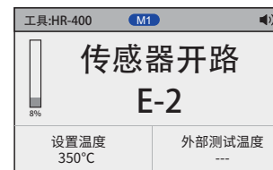
E-2: 传感器开路 处理措施: 建议返厂维修
