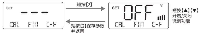
注:当设定为“ON”时开启微调,此时调节温度参数值以一个单位步进,设定为“OFF”时以五个单位步进
